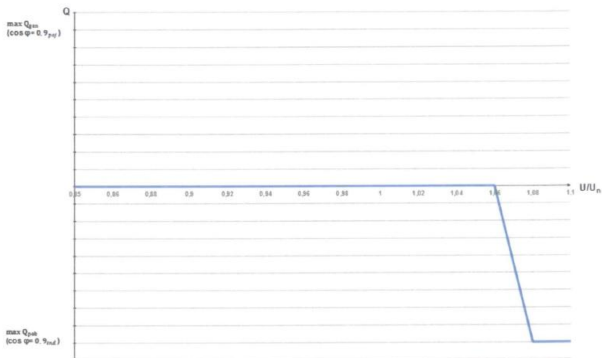
Rys.4. Charakterystyka sterowania mocą bierną w funkcji napięcia dla mikointalacji podłączonych jednofazowo, wymagana przez OSDn.
